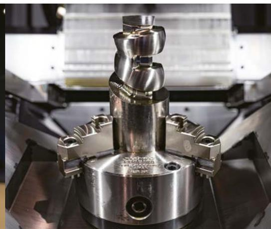
produktiv wie die herkömmlichen BT30-Werkzeuge, ist aber für die Fünf-Achsen-Bearbeitung einsetzbar, was die Herstellung von kleinen Motorgehäusen, Batteriegehäusen, Getriebedeckeln, Lagerschilden, Pumpen, Gehäusen, Wechselrichtergehäusen und vielen anderen Komponenten von Elektrofahrzeugen ermöglicht.
