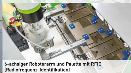
6-achsiger Roboterarm und Palette mit RFID (Radiofrequenz-Identifikation)
