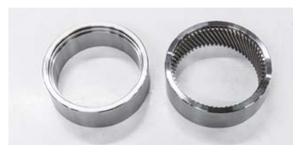
(Слева) Компонент до обработки протяжкой (Справа) Компонент после обработки протяжкой
