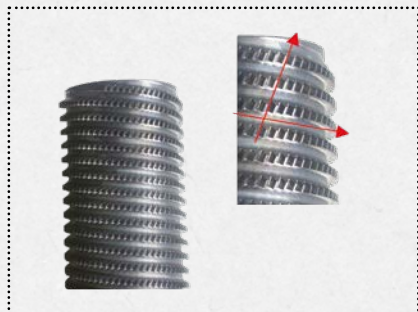
Протяжки с винтовыми канавками (не под прямым углом к оси)
