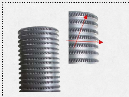
Протяжки с кольцевыми канавками (под прямым углом к оси)
